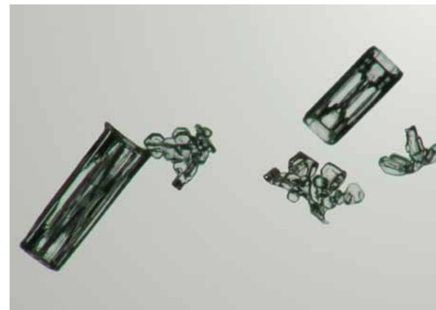
Formas de los cristales de hielo: a la izquierda, columnas con su característica forma cilíndrica o trapezoidal y, a la derecha, pequeñas partículas reconocibles.
